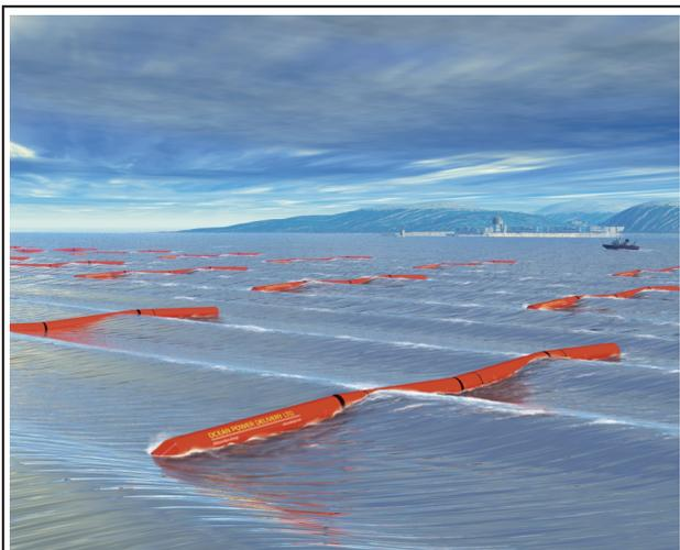
**FIGURA 2** Dispositivo di conversione dell'energia ondosa PELAMIS
