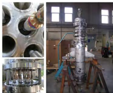
Fig.1. - Reattore di reforming a membrana riscaldato con sali fusi sviluppato nel progetto CoMETHy
