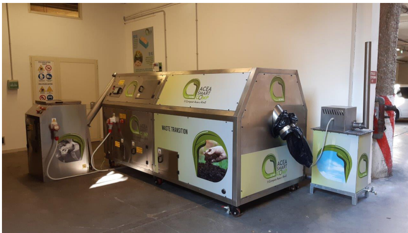
Impianto di compostaggio per il trattamento in proprio di scarti organici, destinato a comunità e grandi utenze (mense, ospedali, centri commerciali, aeroporti, stazioni, fiere ecc.). È stato realizzato da ACEA Elabori (Gruppo ACEA) nell'ambito del progetto "Smart Comp", inteso a costruire una rete diffusa di piccoli impianti delocalizzati. La collaborazione dell'ENEA con ACEA Elabori si esplica, tra l'altro, con corsi di formazione destinati ai conduttori degli impianti
