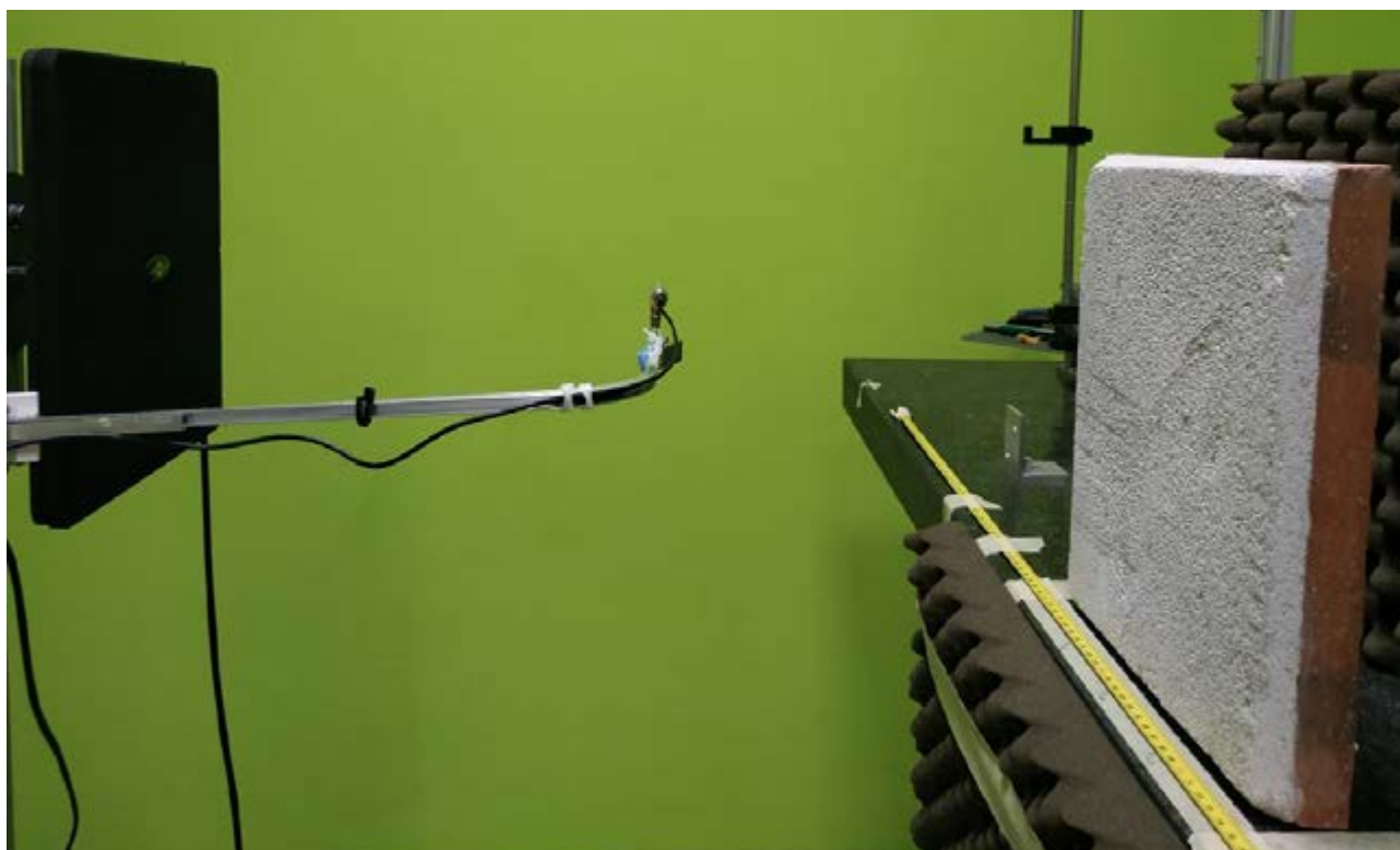
Fig. 1 Misure di laboratorio vengono effettuate per studiare le riposte standard delle murature imbevite, nella figura si notano i trasduttori di emissione e ricezione del dispositivo ACEADD.
