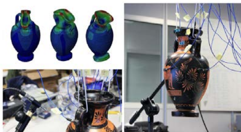
Fig. 4 Matera. Documentazione 3D, prove sperimentali e analisi numeriche sul comportamento dinamico di manufatti archeologici
