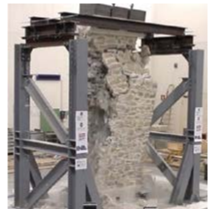
Fig. 2 Collasso durante prova su tavola vibrante di un pannello in muratura storica tipica della zona epicentrale della sequenza sismica dell'Italia centrale 2016-2017- paramento esterno.
