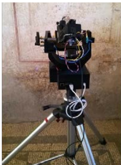
Fig. 2 Dimostratore Califfo a Villa dei Quintili. Il Sistema compatto per imaging LIF CALIFFO (Compact Advanced Laser Induced Fluorescence Friendly Operating system) è un dimostratore per misure di fluorescenza indotta da laser a scansione, di dimensioni e peso ridotti per misure in sito.
