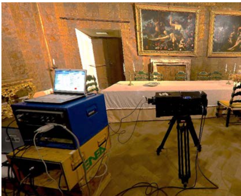
Fig. 4 Prototipo ENEA IR-ITR operante presso il Museo del Barocco a Palazzo Chigi di Ariccia. Il prototipo è stato utilizzato per acquisire il modello 3D con l'imaging sub-superficiale di alcuni dipinti eseguiti a più mani ove erano stati ipotizzati ripensamenti. L'adeguamento del prototipo all'utilizzo in situ al Museo ha riguardato l'ottimizzazione delle ottiche per la misura remota nella sala.
