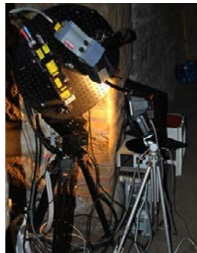
Fig. 1 Foto del prototipo ENEA LIF-Art laser scanner di fluorescenza risolta spettralmente e in tempo nella catacomba di S. Alessandro a Roma. Le modifiche per operare nel ridotto ambiente ipogeo hanno riguardato il sistema di supporto e il riscaldamento aggiuntivo delle ottiche.
