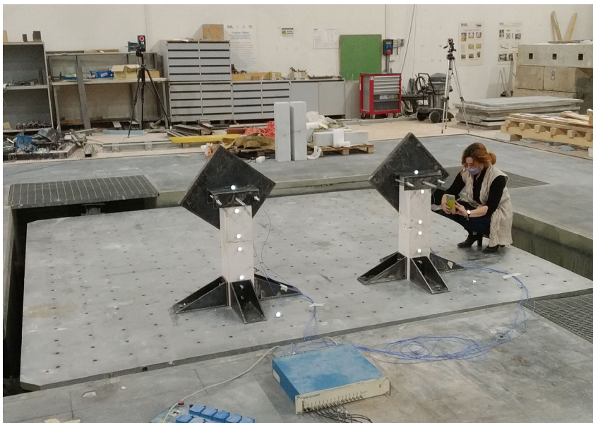
Fig. 1 Allestimento di prova su tavola vibrante per il confronto della resistenza a vibrazione sismica di un provino in marmo ricomposto con tecnica tradizionale (sinistra) e uno ricomposto con sistema RestArt (destra)
