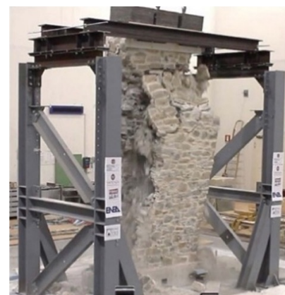
Fig. 2 Collasso durante prova su tavola vibrante di un pannello in muratura storica tipica della zona epicentrale della sequenza sismica dell'Italia centrale 2016-2017- paramento esterno.
