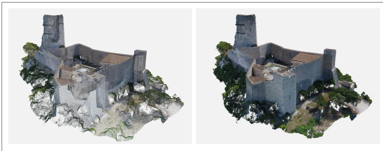
Fig. 1 Rappresentazione digitale della Rocca Janula, nello stato attuale con le lacune (sinistra, elaborazione di rilievo fotogrammetrico da drone) e nella possibile condizione post intervento di inserimento degli stampati 3d (destra, modello texturizzato)
