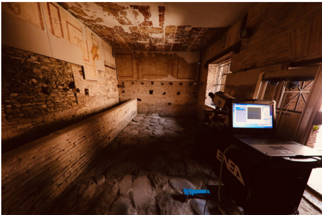
Fig. 1 Il sistema LIF Forlab durante la campagna di misure VADUS presso il Parco Archeologico di Ostia Antica. Anno 2021 - Fonte: ENEA
