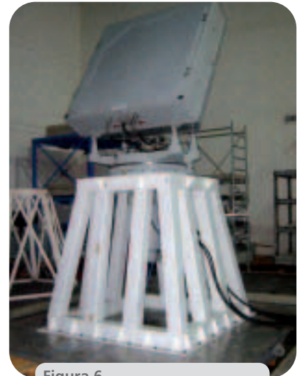
Figura 6 Test dinamico/funzionali su sistema d'antenna radar Fonte: ENEA
