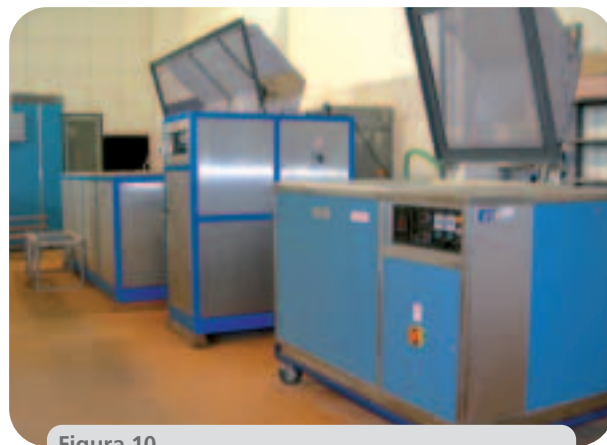
Figura 10 Camere climatiche e camere a nebbia salina per qualifica ambientale di componenti e sistemi nucleari Fonte: ENEA
