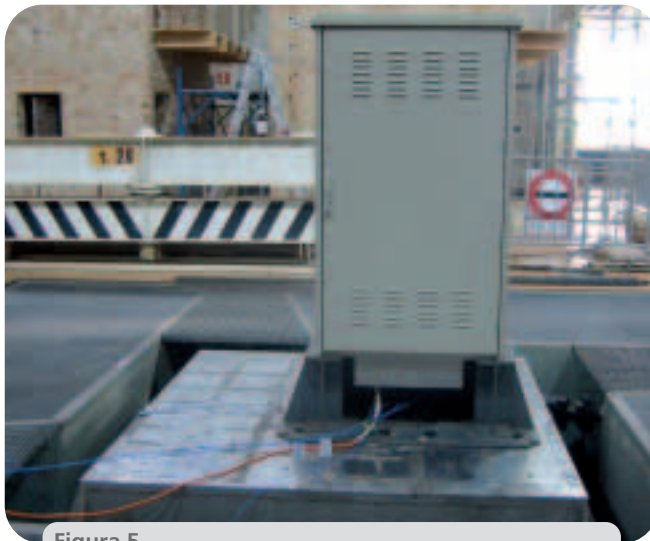
Figura 5 Test dinamico/funzionale su componentistica elettronica Fonte: ENEA
