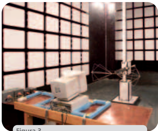
Figura 3 Vista interna della camera semianecoica Vecuvia Fonte: ENEA
