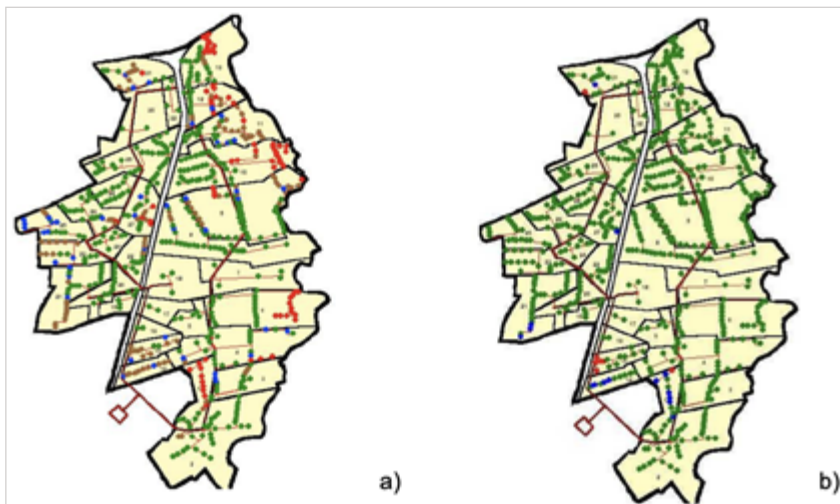
Figura 1 – Individuazione delle aree con deficit di pressione (portata: a) 1200 l/s; b) 700 l/s).
