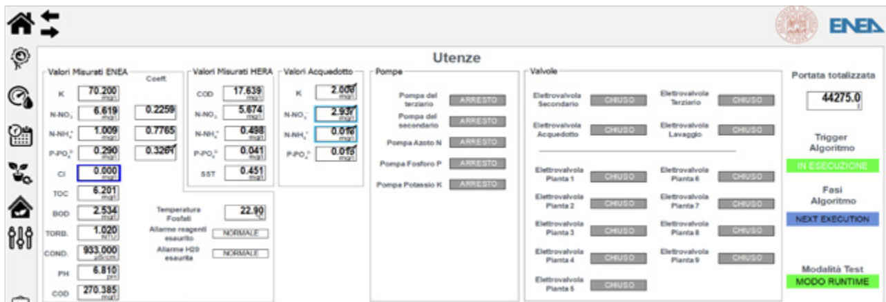
Figura 1: Interfaccia grafica della centralina di monitoraggio online della qualità dei reflui, con l'indicazione dei parametri misurati on-line (K, N-NO 3 , N-NH 4 , P-PO 4 , Cl, TOC, BOD, Torbidità, Conducibilità, pH, COD) mediante le sonde costituenti il prototipo di monitoraggio.
