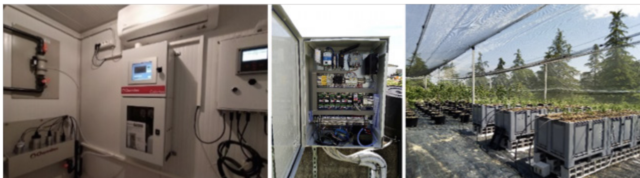
Figura 3: Da sinistra: a) Prototipo di monitoraggio real time della qualità delle acque reflue depurate, in allestimento containerizzato per l'alloggiamento delle sonde di misura per l'analisi dei reflui campionati; b) centralina di controllo per l'elaborazione dati e implementazione logiche fertirrigue; c) parcella coltivata sperimentale con piantumazioni in vaso di pomodoro e pesco irrigate con effluenti depurati (a cura del Partner di progetto CIRI FRAME di UNIBO).
