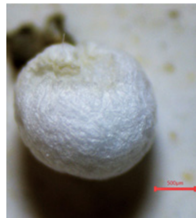
Fig. 1: Identificazione morfologica allo stereomicroscopio di una microparticella rinvenuta in un campione di un impianto di trattamento reflui.
