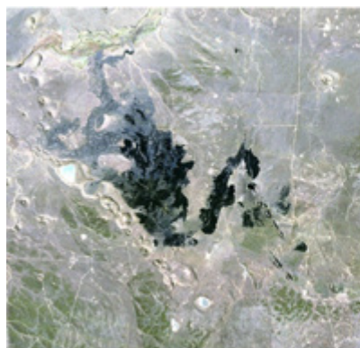
Fig. 1 - Rappresentazione a colori naturali e falsi colori. La presenza delle bande che abbracciano differenti regioni dello spettro elettromagnetico, permette l'osservazione della superficie terrestre con varie sintesi cromatiche RGB. In alto: colate laviche (colore naturale e falso colore); in basso: area pedemontana veneta in differenti sintesi cromatiche in falso colore che permette la discriminazione fra le aree vegetate (in rosso) e suoli-aree antropizzate (in ciano) e falso colore in cui è possibile discriminare il reticolo stradale e i centri urbani (viola) e aree vegetate (in verde brillante) (immagini Landsat 7ETM - USGS).
