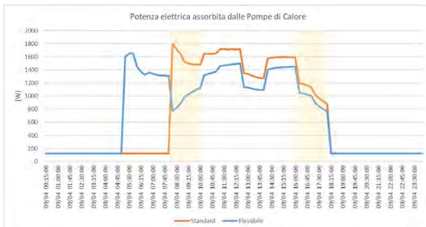
Figura 4: Esempio di modulazione dei carichi termici nel Living Lab F40, al variare del controllo
