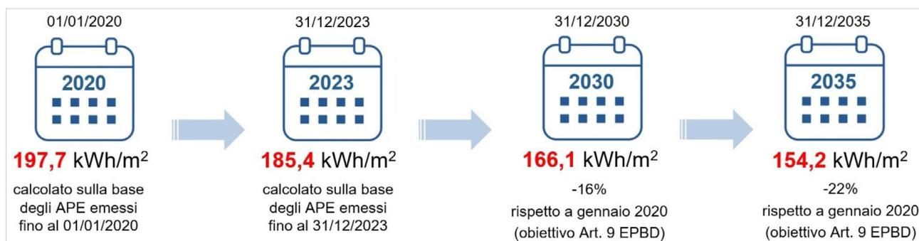
Figura 2: Traiettorie di riduzione dell'E<sub>pgl,nren</sub> medio (kWh/m<sup>2</sup> anno) del parco immobiliare residenziale definita sulla base dei dati presenti sul SIAPE. Fonte: ENEA
