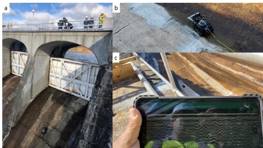
Figura 4. Robot per la manutenzione di impianti idroelettrici
