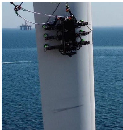
Figura 3: Robot "arrampicatore" per la manutenzione di torri di generatore eolico
