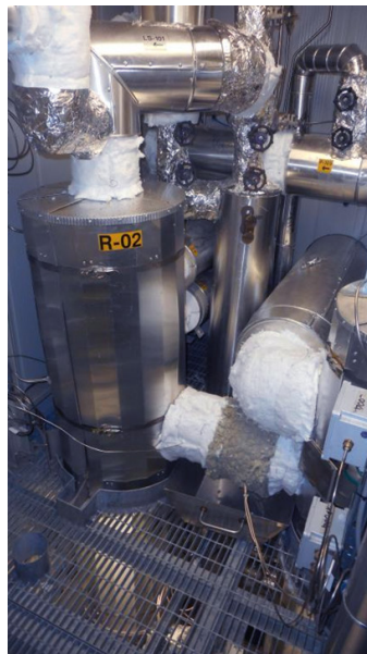
Fig. 3 Impianto CoMETHy per la produzione di idrogeno mediante steam reforming a bassa temperatura alimentato da calore solare (Centro Ricerche ENEA Casaccia)
