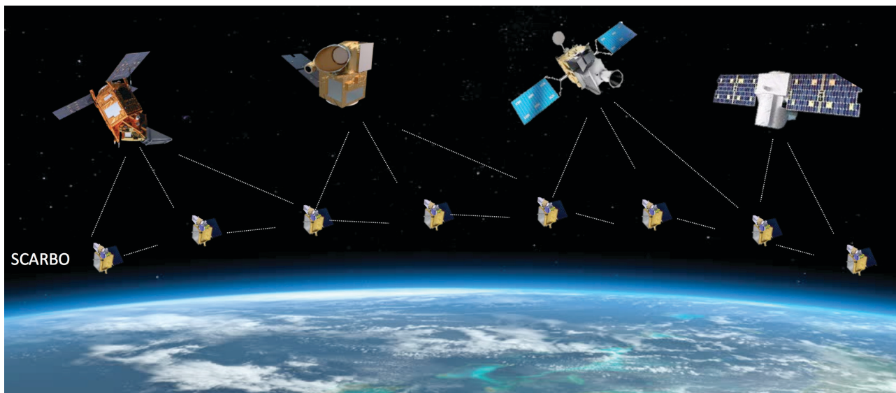
Fig. 2 La piattaforma basata su OneWeb utilizzata come base per il concetto di costellazione SCARBO insieme alle missioni oggi operative
