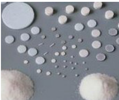
Fig. 1a Polveri e pastiglie di LiF di varie forme, dimensioni e drogaggio utilizzate per dosimetri termoluminescenti
