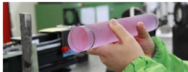
FIGURA 13 Una delle barre di vetro al neodimio fosfato che costituiscono il mezzo attivo per la amplificazione della luce
