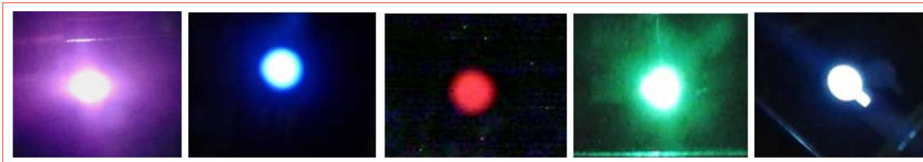
FIGURA 7 OLED con differenti colori di emissione Fonte: ENEA, Dip. Sostenibilità dei sistemi produttivi e territoriali, Divisione Tecnologie e processi dei materiali, Laboratorio Nanomateriali e Dispositivi
