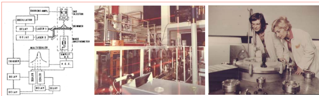
FIGURA 3 Schema e foto della Camera MPD realizzata a Frascati per esperimenti indotti da una o due radiazioni laser (sorgenti commerciali a \text{CO}_2 ). Il percorso dei fasci laser infrarossi è visualizzato mediante laser visibile a HeNe. Nella terza immagine, due ricercatrici (A. Giardini e R. Fantoni) durante l'allineamento
