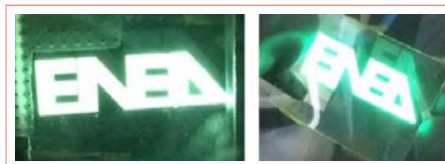
FIGURA 9 Logo ENEA realizzato con OLED su vetro e su plastica Fonte: ENEA, Dipartimento Sostenibilità dei sistemi produttivi e territoriali, Divisione Tecnologie e processi dei materiali per la sostenibilità, Laboratorio Nanomateriali e Dispositivi
