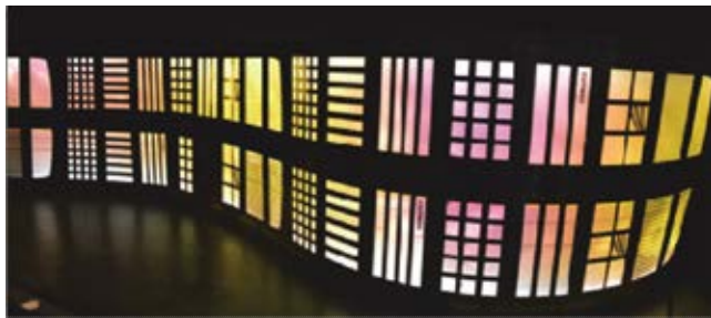
FIGURA 1 Esempio di OLED flessibili con processo di fabbricazione in tecnologia su nastro continuo (roll-to-roll) Fonte: Fraunhofer COMEDD
