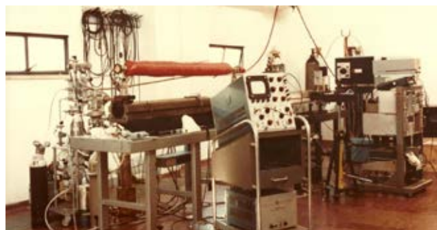
FIGURA 5 Foto del prototipo di reattore per arricchimento isotopico via laser di freon operante con processo MPE indotto da laser a \text{CO}_2
