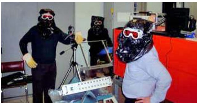
FIGURA 5 Ricercatori del Laboratorio Eccimeri durante una misura della distribuzione spaziale dell'intensità UV emessa dal prototipo di lampada eccimero a scarica silente [28, 29] Fonte: ENEA
