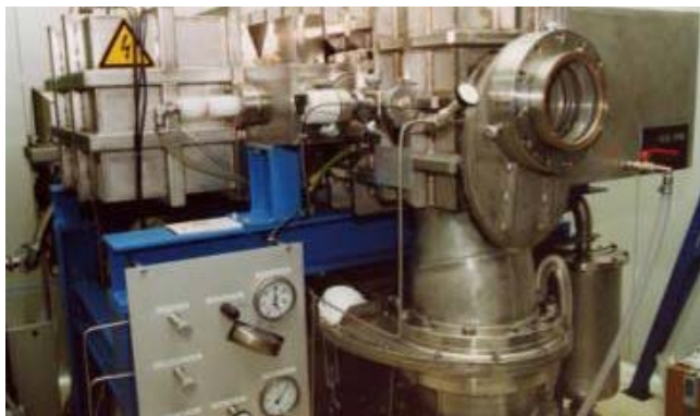
FIGURA 2 Vista laterale del sistema laser eccimero Hercules L, progettato e realizzato dal Laboratorio Eccimeri, ENEA Frascati in collaborazione con El.En. SpA. Da sinistra a destra: camera da vuoto contenente il diodo a raggi X, sistema di controllo della miscela laser, testa laser con la finestra di uscita degli impulsi laser 10 cm x 10 cm, parte del tubo di ricircolo longitudinale del mezzo attivo, involucro contenente il modulatore LC-inversion Fonte: ENEA
