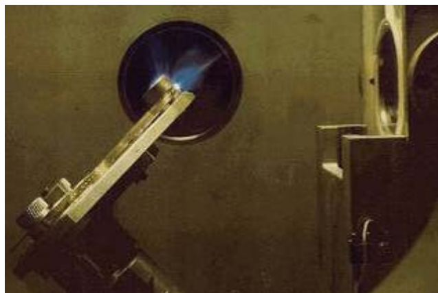
FIGURA 4 Foto all'interno della camera da vuoto durante la generazione del plasma laser. A destra si vede la lente che focalizza l'impulso laser sul sottile nastro metallico montato su un sistema di scorrimento comandato a distanza in modo sincrono con gli impulsi laser, in modo da ottenere emissione da plasma in frequenza di ripetizione. La "piuma" di emissione bluastrea che accompagna l'espansione del plasma dal punto del nastro colpito dall'impulso laser è chiaramente visibile Fonte: [20]
