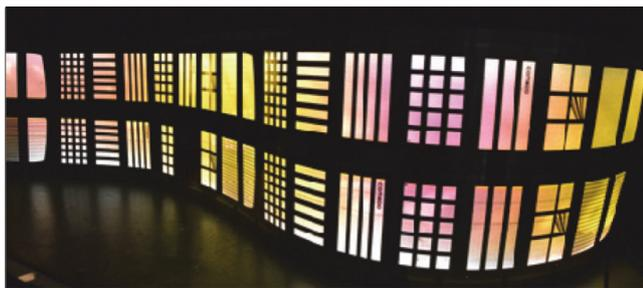
**FIGURA 1** Esempio di OLED flessibili con processo di fabbricazione in tecnologia su nastro continuo (roll-to-roll)
