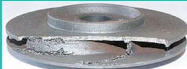
FIGURA 3 Girante di una pompa danneggiata dalla cavitazione
