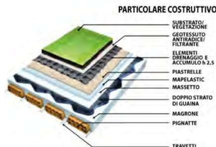
Fig. 3 Prototipo di tetto verde
