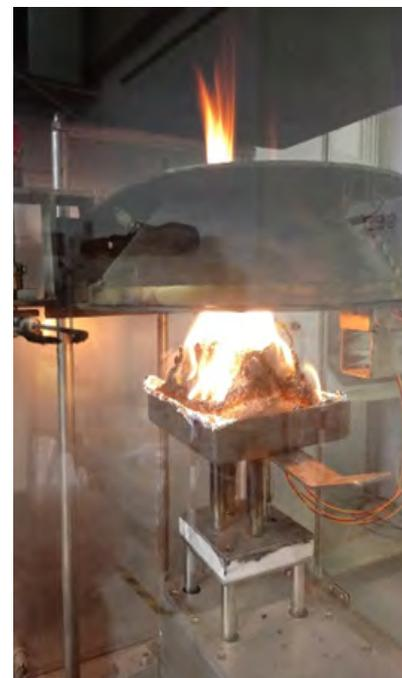
Fig. 3 Prove di reazione al fuoco con il cono calorimetro (metodo ISO 5660) eseguite nel Laboratorio Polimeri del Centro ENEA di Brindisi
