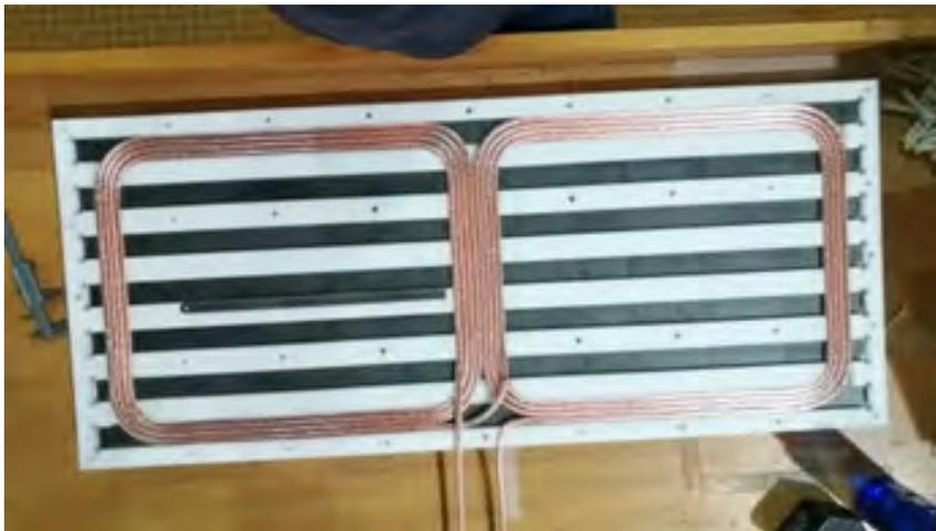
Fig. 5 Bobina primaria sistema wireless dinamico - Fonte: ENEA
