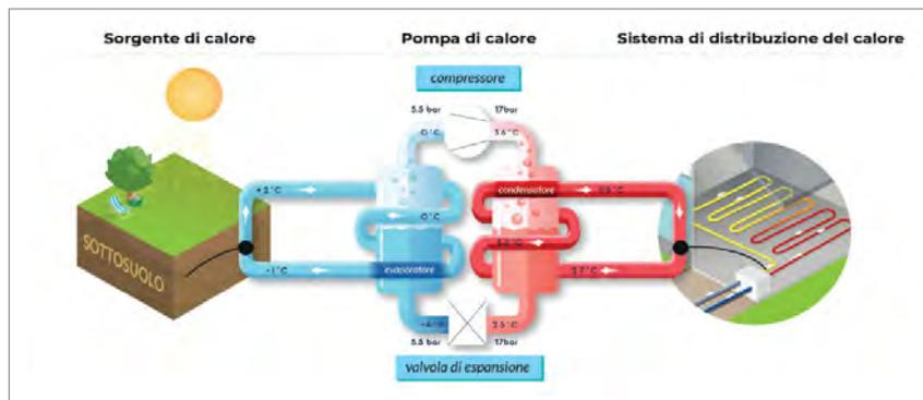
Fig. 1 Schema di funzionamento della pompa di calore
