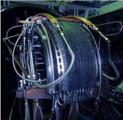
Fig. 2 Prototipo scala 1:1 del bersaglio verticale del divertore di ITER realizzato da ENEA a Frascati (per Ansaldo Nucleare) e provato con successo alle condizioni di lavoro all'interno del reattore
