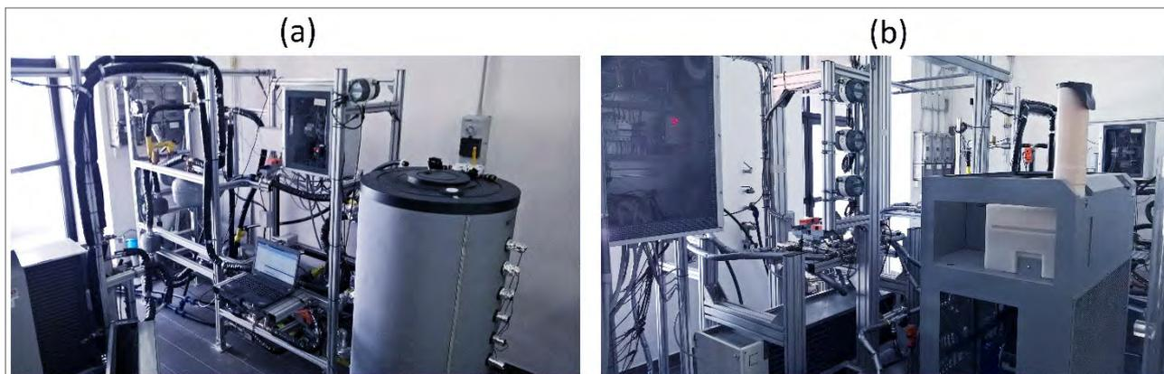
Fig. 1 (a) impianto prove accumulo termico a temperature medio-basse; (b) impianto prove accumulo del freddo
