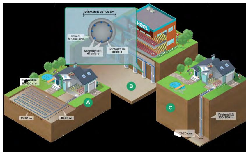
Fig. 2 Sistemi a circuito chiuso: scambiatori orizzontali (A), geostrutture (B), sonde geotermiche verticali (C)
