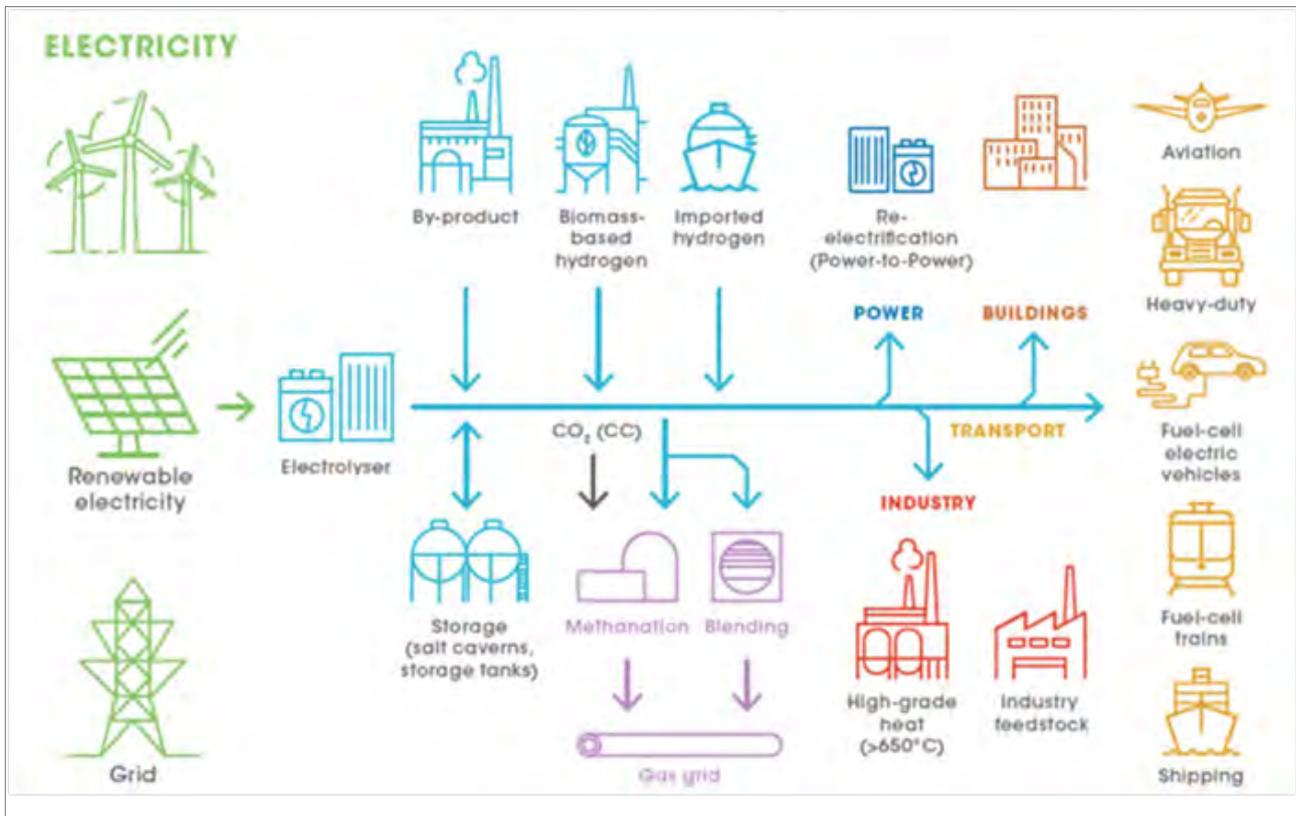
Fig. 1 Schema della filiera tecnologica PtG -Fonte [2]
