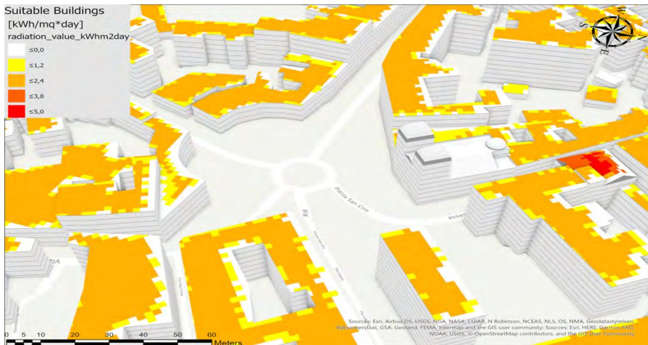
Fig. 5 La mappa relativa alla piazza S. Ciro di Portici, riporta la resa energetica in kWh/mq\* day e tiene conto, oltre che della struttura reale dei tetti, anche di una molteplicità di possibili ulteriori effetti tra cui: ombreggiatura reciproca degli edifici, possibili effetti derivanti dalla vegetazione, presenza di aree non effettivamente utilizzabili ecc. Il metodo è estendibile anche alle facciate degli edifici stessi
