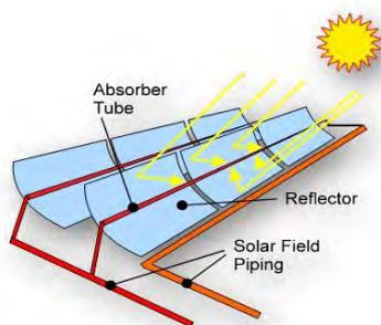
Fig. 1 Schema concettuale di collettori solari a concentrazione
