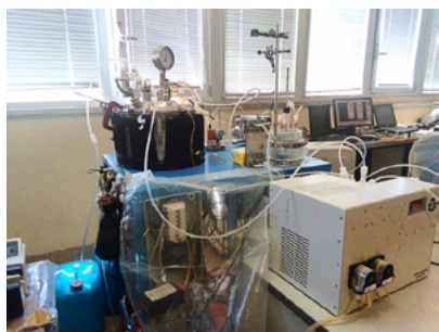
Figura 2: Reattore pilota ibrido (60L) di biometanazione in situ , alimentato con reflui dell'industria casearia.
