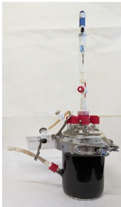
Figura 3. Reattore sperimentale (1L) per l'integrazione di un sistema bioelettrochimico (BEPtG) nel digestore anaerobico per l'upgrading del biogas attraverso la riduzione in-situ della CO_2 a CH_4 .
