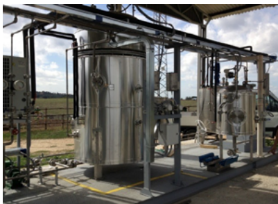
Figura 1. Impianto prototipo processo doppio stadio per la produzione di idrometano (brevetto ENEA/CREA n. 0001416926).
