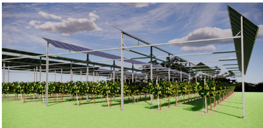
Figura 2: Rendering del sistema agrivoltaico avanzato proposto
