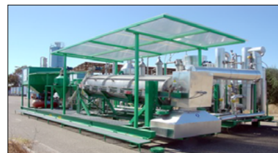
Figura 2: Impianto di pirolisi su skid, centro Ricerche ENEA Trisaia.
