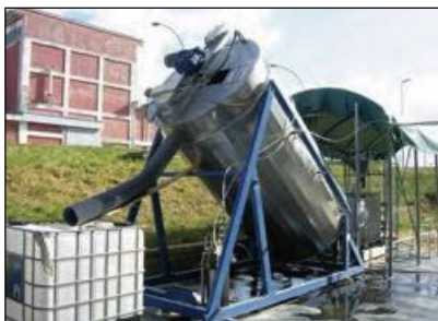
Figura 3: prototipo di impianto mobile di digestione anaerobica (6 m 3 , 2/3 KWt), centro Ricerche ENEA Casaccia.
