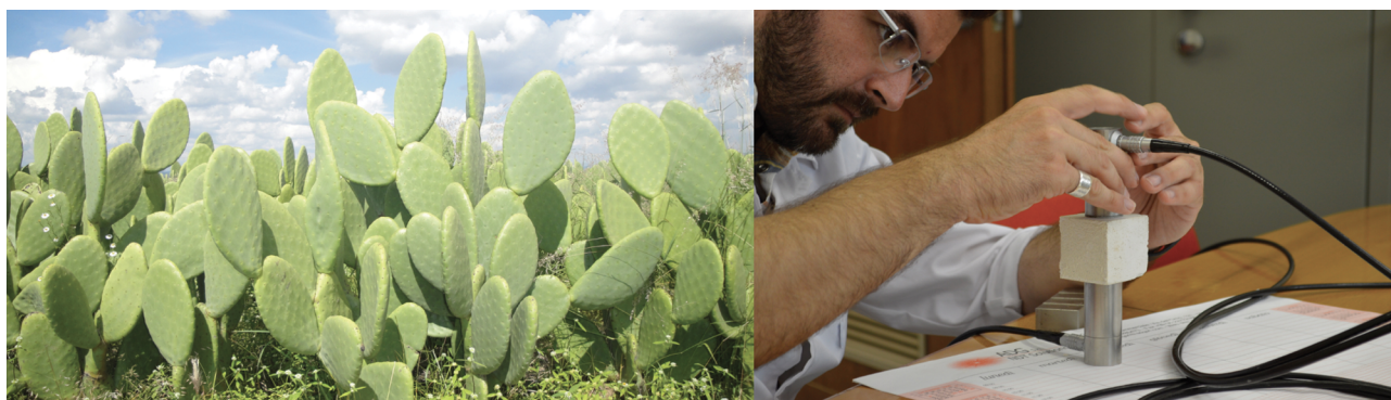
Figura 2 - A sinistra una piantagione di Fico d'India, a destra una malta prodotta con la mucillagine come additivo, analizzata agli ultrasuoni per valutarne la qualità
