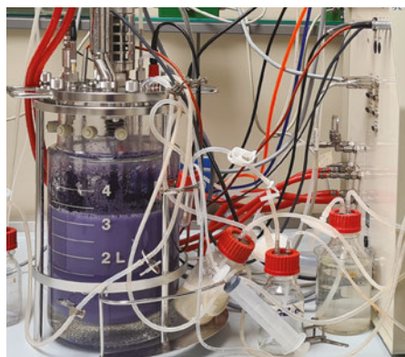
Figura 2 - Bioreattori scala banco utilizzati per la produzione di microrganismi pigmentati: ceppo ELP2022 appartenente al genere Rhodotorula (sinistra), ceppo DSM1522 di J. lividum (destra).
