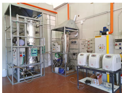
Figura 2 - Immagine di bioreattore pilota per la produzione idrogenotrofa di metano presso il Centro Ricerche ENEA di Brasimone.
