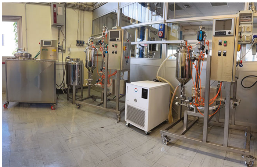
Figura 3 – Sistemi continui di filtrazione (micro e ultrafiltrazione; nanofiltrazione e osmosi inversa) tangenziale a membrana presso Hall Tecnologica Processi Agroindustriali (CR Casaccia, Roma).
