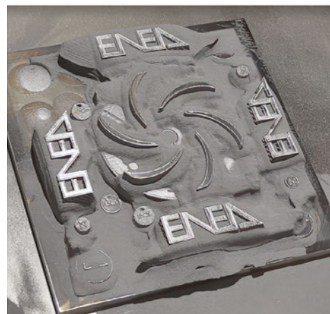
Campioni stampati in 3D in lega di titanio mediante EBM
