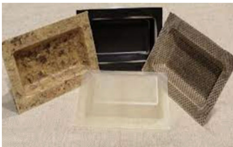
Film in Bioplastica (PLA) tal quali e funzionalizzati
