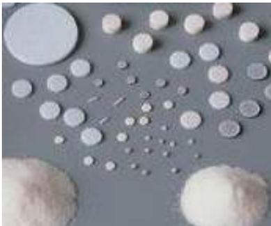
Fig. 1a Polveri e pastiglie di LiF di varie forme, dimensioni e drogaggio utilizzate per dosimetri termoluminescenti
