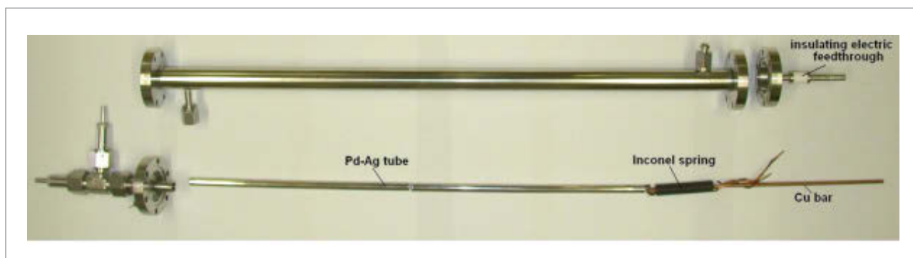
Fig. 5 Reattore a membrana sviluppato in collaborazione con CEA per la detritizzazione del JET di Culham in Gran Bretagna
