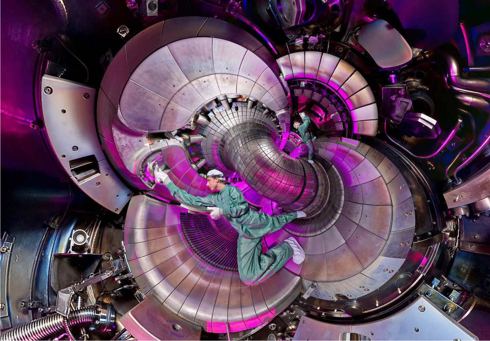
Particolare dell' ASDEX Upgrade, divertor tokamak operativo dal 1991 presso il Max-Planck-Institut für Plasmaphysik a Garching, in Germania. È una delle macchine di media dimensione utilizzate per preparare la base di fisica per i futuri reattori ITER e DEMO
