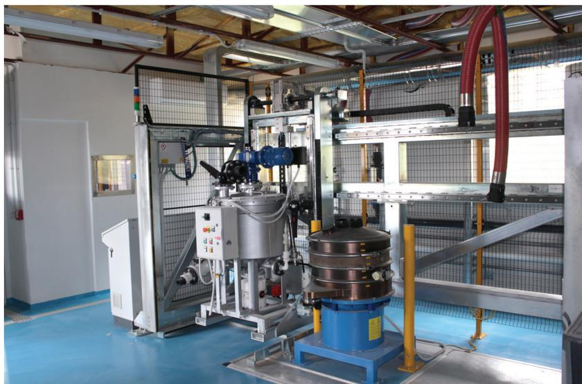
Particolare dell'impianto dimostrativo ROMEO (Recovery Of MEtals by hydrOMetallurgy) realizzato nel Centro Ricerche Casaccia, dedicato al recupero e alla separazione di materiali da matrici complesse per via idrometallurgica
