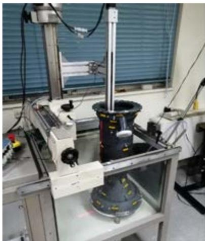
Fig. 3 Controllo UT automatizzato di camera di combustione presso ENEA (courtesy of AVIO)
