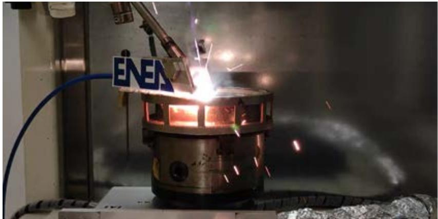
Fig. 2 Test di Saldatura laser "key hole" di superlega di nichel IN 718 per la messa a punto di processi di saldatura per motori aerospaziali;
