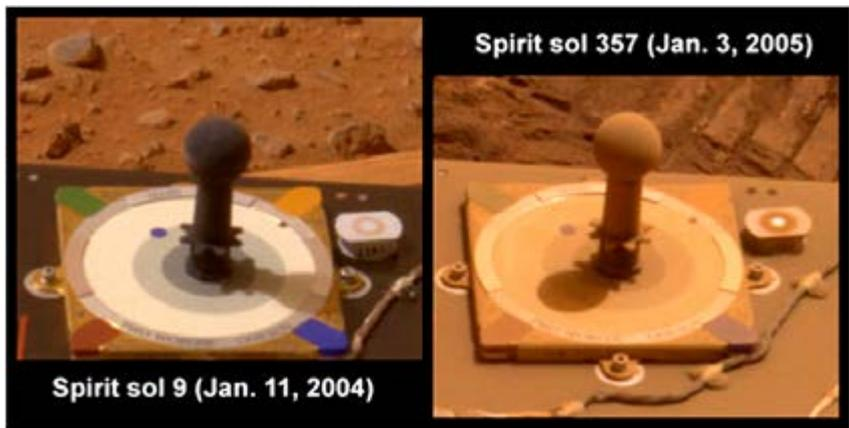
Fig. 4 La meridiana/bussola solare del rover Spirit su Marte. La foto di destra mostra chiaramente l'effetto delle polveri marziane dopo un solo anno
