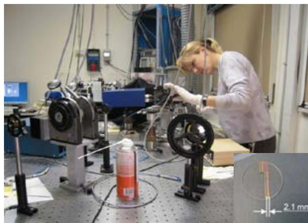
Fig.3 Banchi ad hoc per la caratterizzazione ottica dei componenti a film sottili. A sinistra: Misura di trasmittanza di un filtro uniforme di grandi dimensioni, rif. Fig. 1. A destra: Misura di trasmittanza di un filtro lineare variabile, rif. Fig.2. La zona di variazione è illustrata nell'inserto sotto
