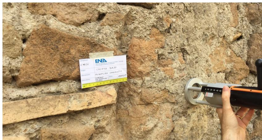
Fig. 5 Prova penetrometrica sulle malte delle murature della chiesa/convento di Santa Caterina
