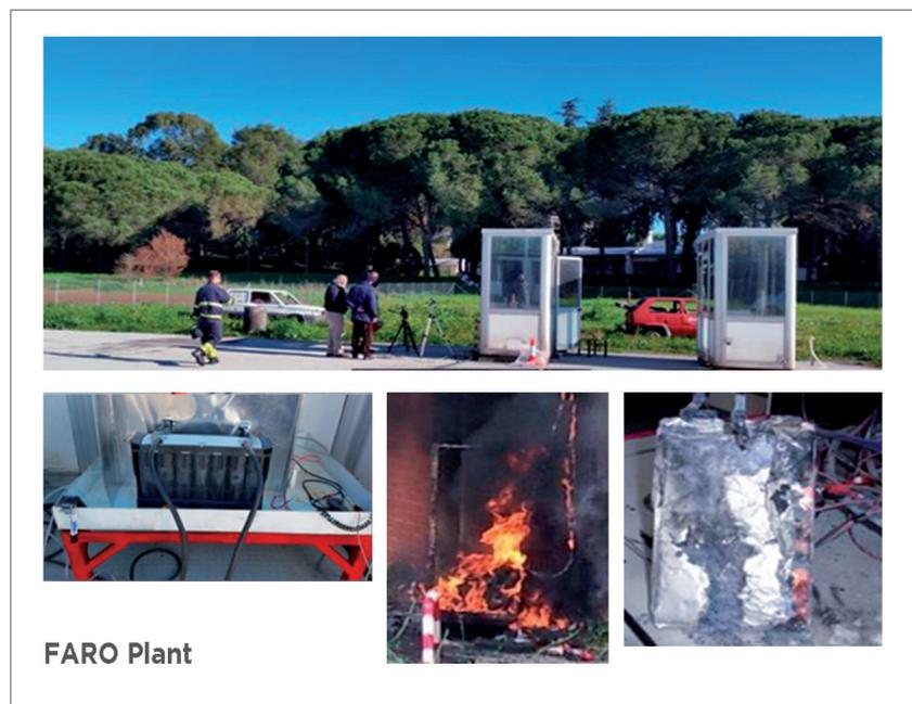
Fig.4 Impianto FARO e prove di abuso su sistemi litio-ione
