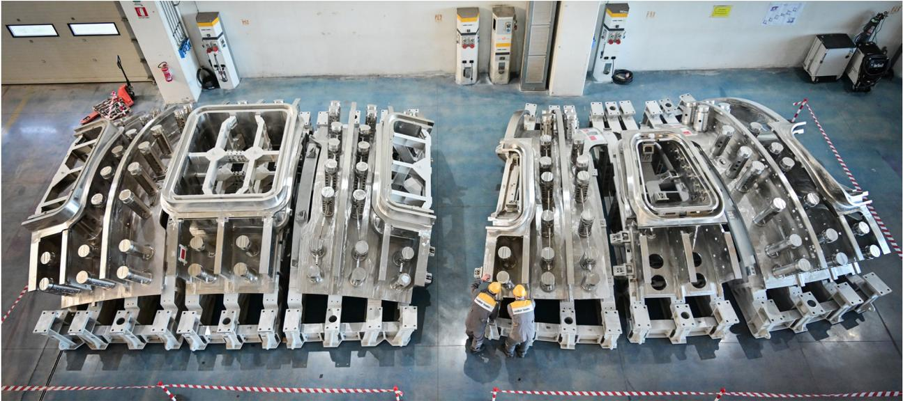
Inoltre, dopo aver prodotto il prototipo della cassetta del divertore, l'azienda si è aggiudicata la prima serie di 15 unità. Per di più, diverse sono le collaborazioni avviate per la fabbricazione di componenti di dimensioni inferiori, ma comunque tecnologicamente molto avanzati. Abbiamo anche contribuito al programma JT-60SA fabbricando 20 casse di contenimento delle bobine del magnete toroidale.
