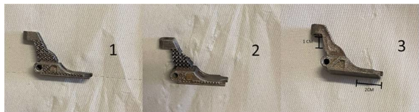
Figura 3 - Maniglia stampata con Electron Beam Melting con varie strutture (Inspiration) [1].
