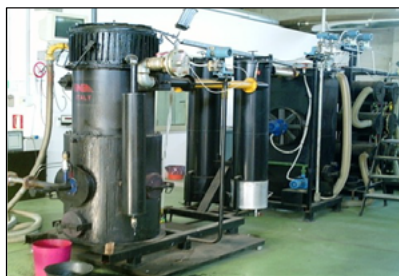
Figura 1: gassificatore di biomasse di tipo downdraft, centro Ricerche ENEA Trisaia.
