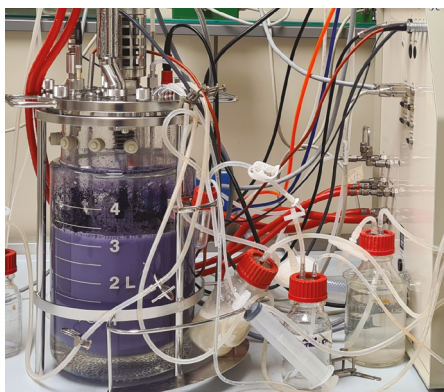
Figura 2 - Bioreattori scala banco utilizzati per la produzione di microrganismi pigmentati: ceppo ELP2022 appartenente al genere Rhodotorula (sinistra), ceppo DSM1522 di J. lividum (destra).
