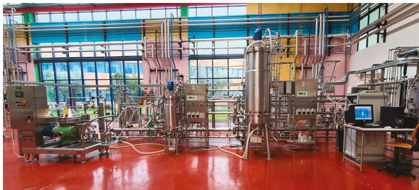
Figura 1 - Impianto biotecnologico presso il Centro di Innovazione Integrato "Agrobiopolis" del Centro Ricerche ENEA della Trisaia con bioreattori da 50 e 500 litri.
